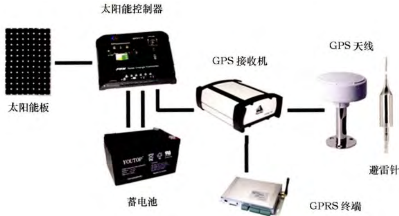
图 3 GPS 变形监测硬件部分的组成与连接示意图
